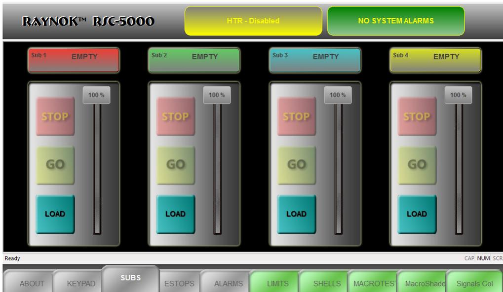
THE RJC-5000 CONSOLE SUBMASTERS SCREEN AS SEEN ON A SC5500 CONSOLE
